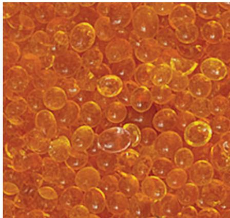
La conception à vision claire à 360 degrés facilite l'inspection à distance de la saturation du gel de silice à couleur changeante. Le gel de silice inerte passe de l'or au vert foncé pour indiquer visuellement l'adsorption de l'humidité et confirmer que le reniflard fait bien son travail.
