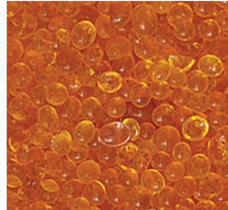
Das 360 Grad Klarsicht-Design macht es einfach, die Farbsättigung der sich wechselnden Kieselgel-Farbe aus der Ferne zu prüfen. Das Kieselgel wechselt von einer goldenen zu einer dunkelgrünen Farbe, um die Adsorption von Feuchtigkeit optisch anzuzeigen und um zu bestätigen, dass der Entlüfter seine Aufgabe ordnungsgemäß erfüllt.
