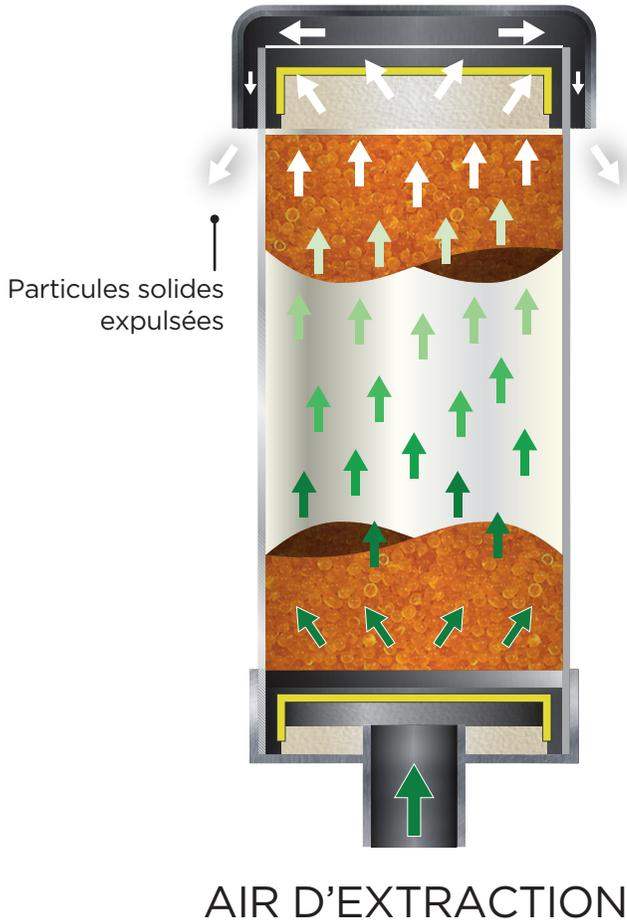
**DIAGRAMME 2** Indique que l'air est expulsé à travers le reniflard déshydratant de l'équipement sur lequel il est monté. Lorsque l'air contaminé parcourt ce chemin en sens inverse, les vapeurs d'eau expulsées sont adsorbées par le gel de silice. Au cours de ce processus de flux d'air inversé, le gel de silice indique la présence d'une humidité excessive à l'intérieur du réservoir, car le gel de silice doré vire au vert foncé à partir du bas du reniflard plutôt que du haut du reniflard.
